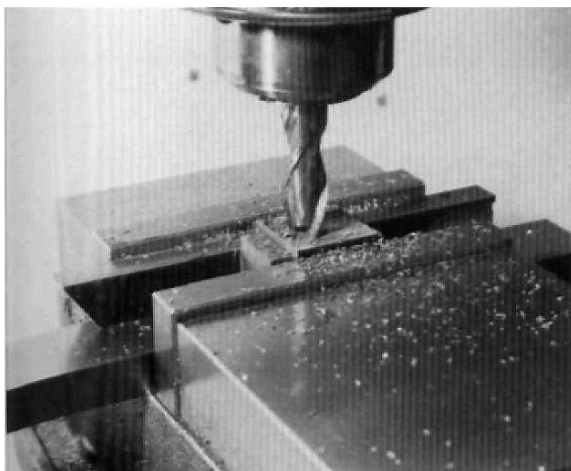
26 - Troisième phase - usinage des surfaces extérieures et mise aux cotes de l'étrier.
