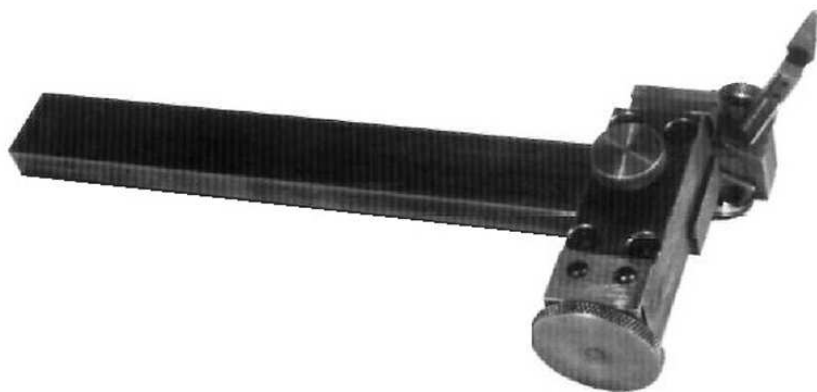
17 - Vue de dos du mécanisme du doigt guide-dent.
