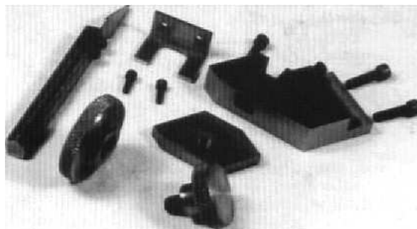
32 - Ensemble des pièces constituant le support-d'indexe
