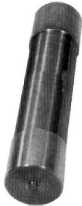
22 - Tampon à mini-maxi fini, utilisé pour déterminer la cote et la cylindricité de la portée de l'alésage du porte-outil pneumatique.
