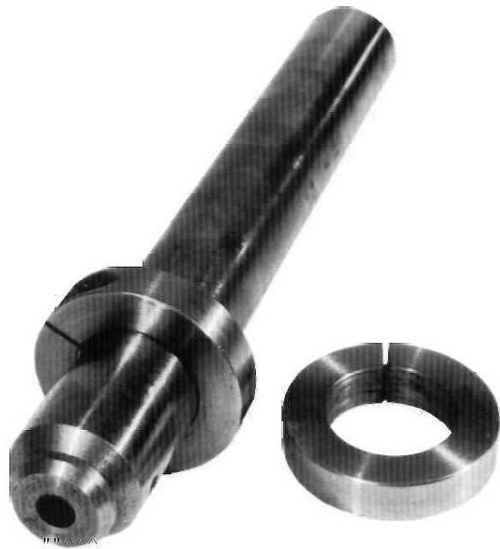
10 - Détail de la broche pneumatique et des colliers de fixations, avec douille de réduction de 3/8", montée dessus.
