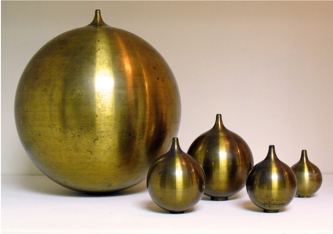
Type de résonateurs ayant servi à Helmholtz pour ses expériences
